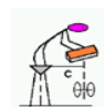
DISTANZA ORIZZONTALE TRA LE MANI E IL PUNTO DI MEZZO DELLE CAVIGLIE - DISTANZA DEL PESO DEL CORPO (DISTANZA MASSIMA RAGGIUNTA DURANTE IL SOLLEVAMENTO)
